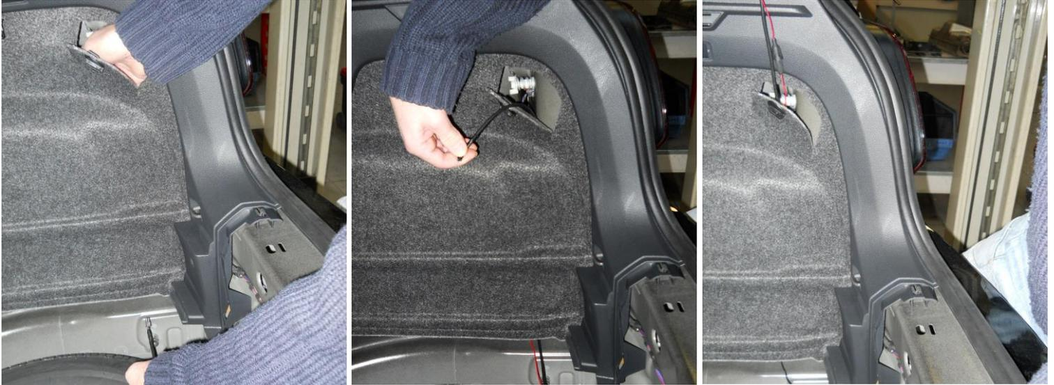
Die Kofferraumleuchte abschließen. Den roten Draht des REMUS Zuleitungskabels zur Öffnung der Kofferraumleuchte verlegen.
