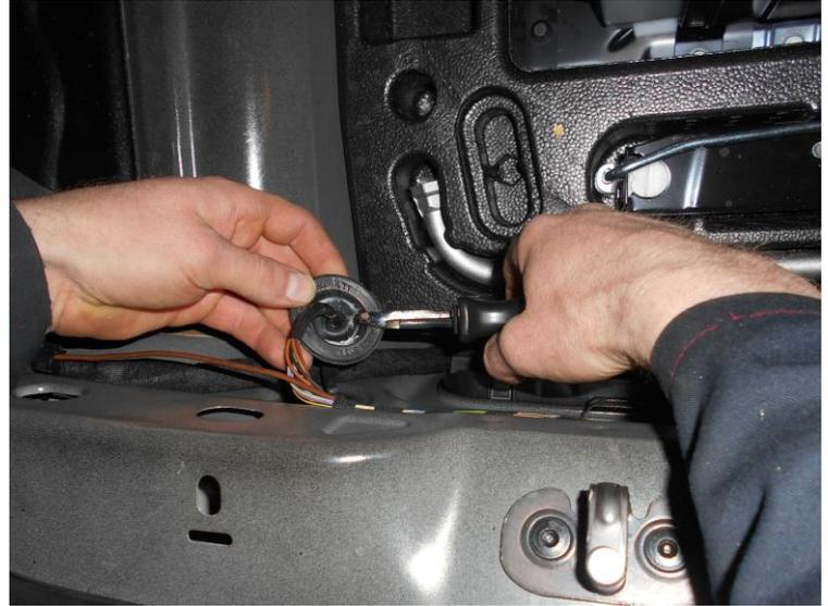
Das REMUS Aktuorkabel unter dem Hitzeschutzblech entlang durch die entstandene Öffnung in den Kofferraum verlegen. Die Gummiabdeckung wieder montieren.
