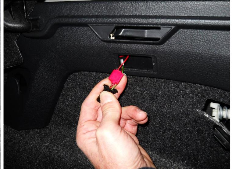
Den schwarzen Draht (-) des REMUS Zuleitungskabels mit Hilfe des Schwachstromverbinders auf den **braunen** Draht des Serienkabelstrangs installieren.
